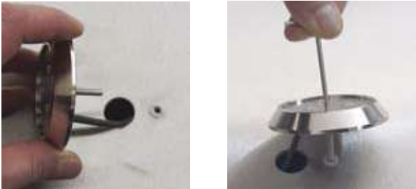
Ejemplo: Montaje con agujeros de perforación de 6,2mm para el manguito roscado y 12mm - 30mm para el conducto del cable
