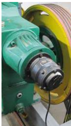
Máquina de SASSI / Liftmaterial sin y con encoder
