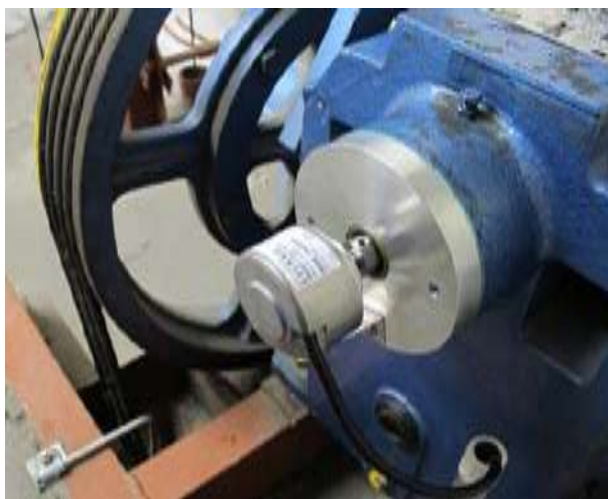
Ejemplo: montaje con encoder
