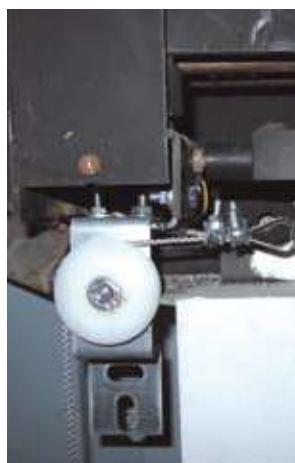
A Fijación de la polea de reenvío
