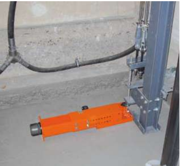
Ejemplos de fijación del soporte de mantenimiento en el soporte del pistón
