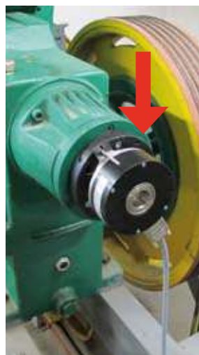
Máquina de SASSI / Liftmaterial sin y con encoder
